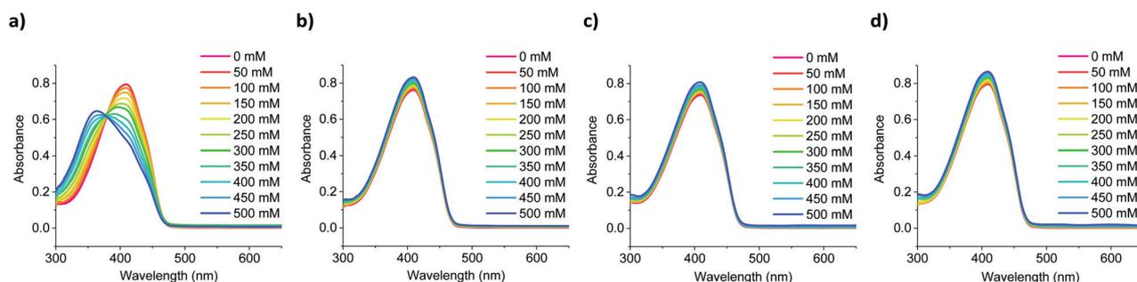
Fig. 3 Representative UV-Vis absorption spectra of **S4** in a 1 : 3 mixture of water : tetrahydrofuran (**S4** concentration  $4 \times 10^{-5}$  M) upon incrementing (a)  $\text{Na}^+$ , (b)  $\text{Li}^+$ , (c)  $\text{K}^+$  and (d)  $\text{Ca}^{2+}$  concentrations (0–500 mM).
