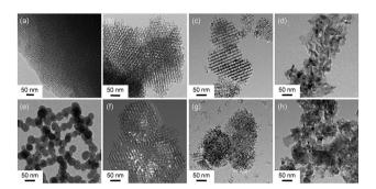
Fig. 2 TEM images of (a) the mesoporous silica template KIT-6, (b) m-Co<sub>3</sub>O<sub>4</sub>, (c) m-NiO, (d) m-Fe<sub>2</sub>O<sub>3</sub>, (e) Au/KIT-6, (f) Au/m-Co<sub>3</sub>O<sub>4</sub>, (g) Au/m-NiO, and (h) Au/m-Fe<sub>2</sub>O<sub>3</sub>.
