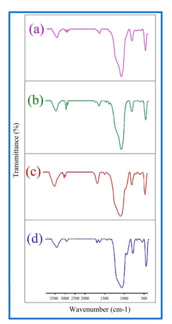
Fig. 6 FT-IR spectra of (a) KIT-6, (b) KIT-6@Cl, (c) KIT-6@SMTU, (d) KIT-6@SMTU@Ni catalyst.
