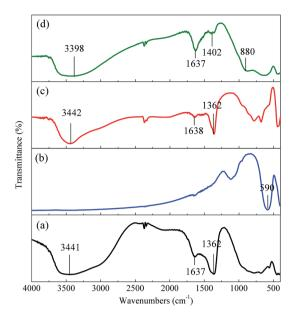
Fig. 6 FTIR spectra of (a) MgAl-LDH, (b)  $CoFe_2O_4$ , (c)  $CoFe_2O_4/MgAl-LDH$ , (d)  $CoFe_2O_4/MgAl-LDH$  after  $Cr(v_1)$  adsorption.
