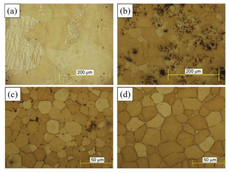
Fig. 19 Refinement effect of Zr and Sr on magnesium alloys (a) Mg; (b) Mg-5Zr; (c) Mg-5Zr-2Sr; (d) Mg-5Zr-5Sr.<sup>204</sup>
