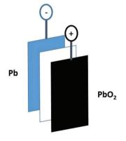
$Pb + PbO_2 + 2H_2SO_4 \longrightarrow 2PbSO_4 + 2H_2O$
