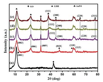
Fig. 1 XRD patterns of GO (a), GO/LDH (b), GO/LDH@Au (c), GO/ LDH@Pd (d), and GO/LDH@AuPd (e).
