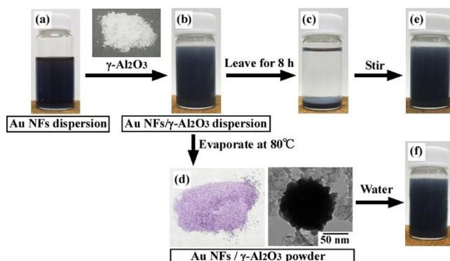
Figure 3. Photographic and TEM images of (a) Au NFs dispersion, (b) Au NFs/ $\gamma$ - $\text{Al}_2\text{O}_3$  dispersion, (c) Au NFs/ $\gamma$ - $\text{Al}_2\text{O}_3$  precipitate, (d) Au NFs/ $\gamma$ - $\text{Al}_2\text{O}_3$  powder, and (e, f) Au NFs/ $\gamma$ - $\text{Al}_2\text{O}_3$  redispersion.
