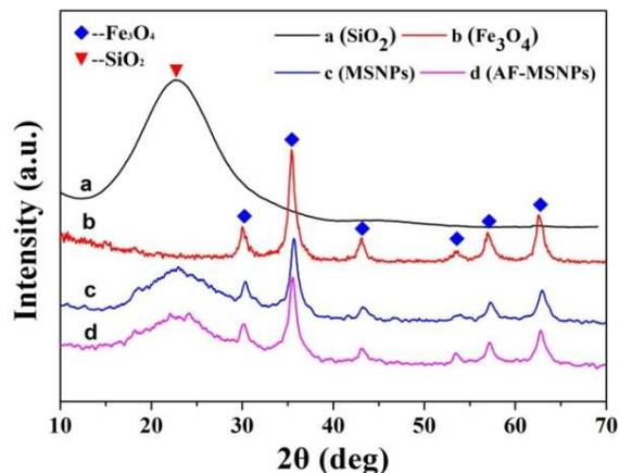
Fig. 2 X-ray powder diffraction of (a)  $\text{SiO}_2$ ; (b)  $\text{Fe}_3\text{O}_4$ ; (c) MSNPs; (d) AF-MSNPs
