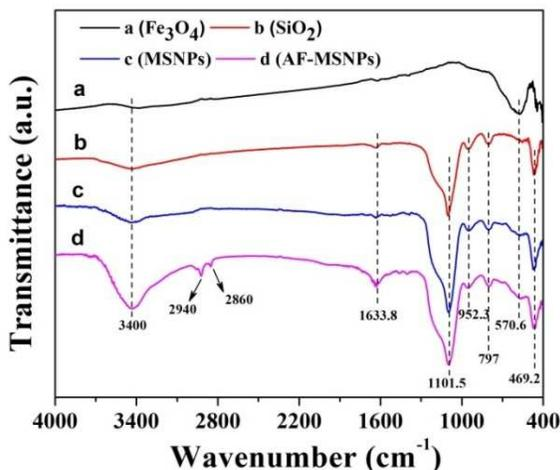
Fig. 1 FTIR spectra of (a)  $\text{Fe}_3\text{O}_4$ ; (b)  $\text{SiO}_2$ ; (c) MSNPs; (d) AF-MSNPs.
