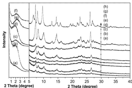
**Figure 7.** Small angle and wide angle XRD patterns of (a) 0Si/Ti-MCM-36(E), (b) 40Si/Ti-MCM-36(E), (c) 80Si/Ti-MCM-36(E), (d) 120Si/Ti-MCM-36(E), (e) 140Si/Ti-MCM-36(E), (f) A-Si/Ti-MCM-36(E), (g) Ti-MWW and (h) Ti-YNU-1.
