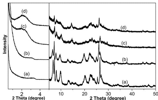
**Figure 3.** XRD patterns of (a) ERB-1(P), (b) MCM-22(P), (c) 40Si/Ti-MCM-36(E) and (d) 40Si/Ti-MCM-36(M).
