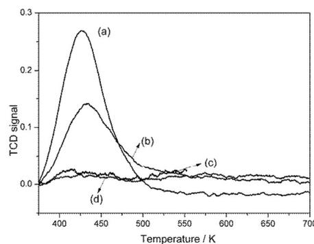
**Figure 11.**  $NH_3$  TPD spectra of (a) ERB-1, (b) 40Si/Ti-MCM-36(E), (c) Ti-YNU-1 and (d) A-Si/Ti-MCM-36(E).
