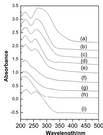
**Figure 6.** DR UV-Vis spectra of (a) 0Si/Ti-MCM-36(E), (b) 40Si/Ti-MCM-36(E), (c) 80Si/Ti-MCM-36(E), (d) 120Si/Ti-MCM-36(E), (e) 140Si/Ti-MCM-36(E), (f) A-Si/Ti-MCM-36(E), (g) Ti-MWW, (h) Ti-YNU-1 and (i) 40Si/Ti-MCM-36(M).
