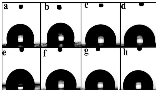
Fig. 5 The contact angles of water (a-b), pH=2 (c), pH=4 (d), pH=6 (e), pH=8 (f), pH=10 (g), pH=12 (h) liquid on  $\text{Co}_3\text{O}_4$  growth AAO super slippery surfaces
