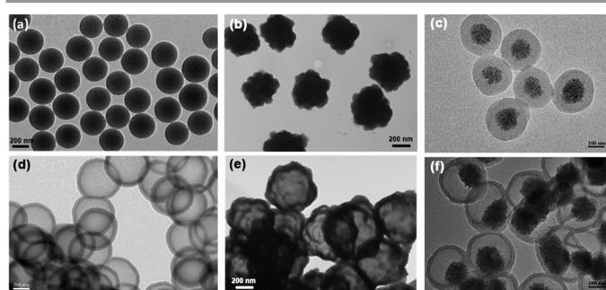
**Figure 1.** TEM images of (a) PMAA microspheres, (b) flowerlike PMAA microspheres, (c)  $\text{Fe}_3\text{O}_4$ @PMAA, (d) H-NCMP, (e) F-NCMP, and (f)  $\text{Fe}_3\text{O}_4$ @H-NCMP.
