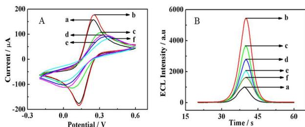
**Fig. 1** (A) CVs for (a) bare GCE, (b) dep-Au/GCE, (c) TBA/dep-Au/GCE, (d) BSA/TBA/dep-Au/GCE, (e) TB/BSA/TBA/dep-Au/GCE, (f) TBA II/TB/BSA/TBA /dep-Au/GCE in 5.0 mM  $[\text{Fe}(\text{CN})_6]^{3-/4-}$  (pH 7.4) at scan rate of  $100 \text{ mV s}^{-1}$ . (B) ECL profiles of (a) bare GCE, (b) dep-Au/GCE, (c) TBA/dep-Au/GCE, (d) BSA/TBA/dep-Au/GCE, (e) TB/BSA/TBA/dep-Au/GCE, (f) TBA II/TB/BSA/TBA /dep-Au/GCE in 0.1 M peroxydisulfate solution.
