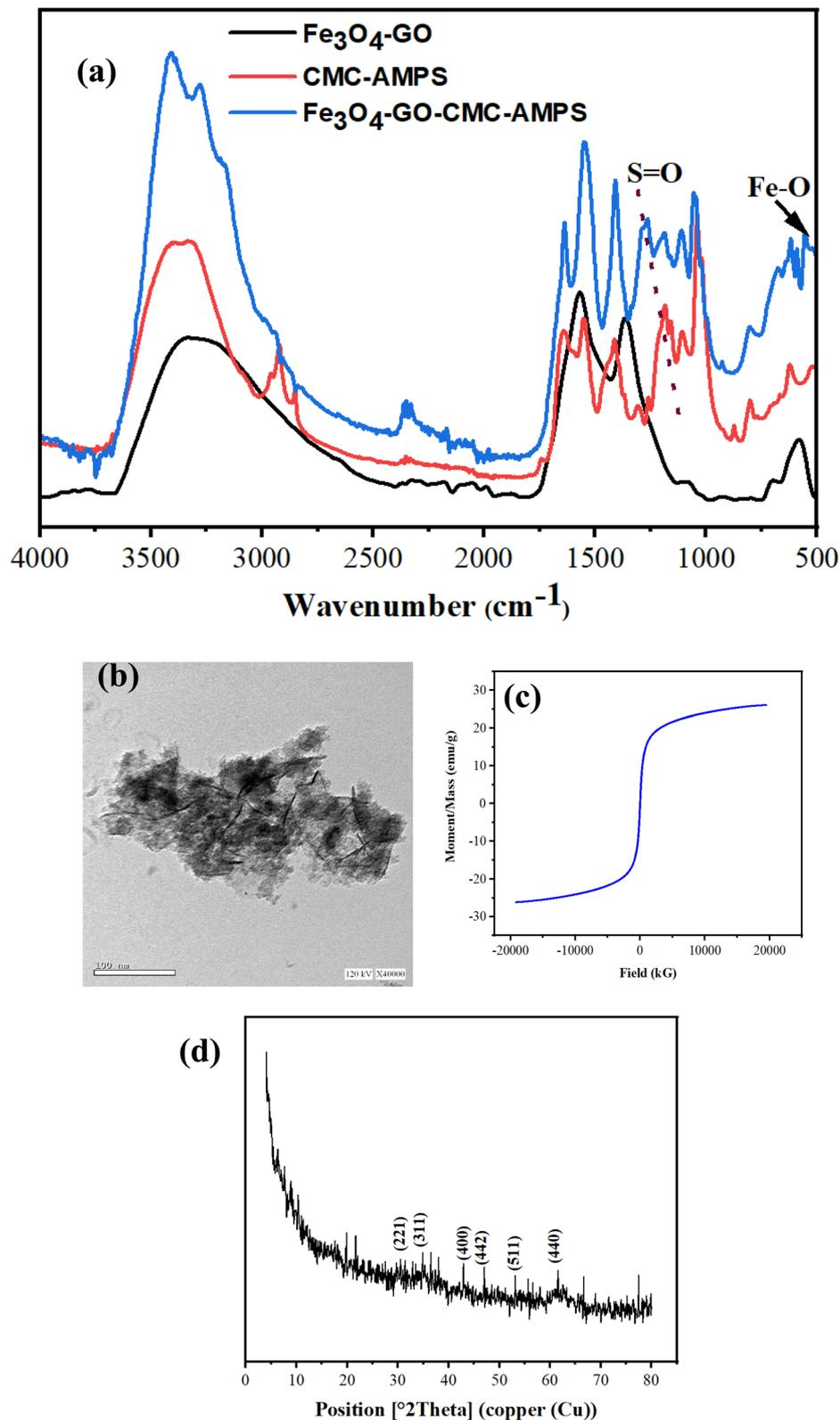
Fig. 2 (a) FTIR of  $\text{Fe}_3\text{O}_4\text{-GO}$ , CMC-AMPS hydrogel, and  $\text{Fe}_3\text{O}_4\text{-GO-CMC-AMPS}$  hydrogel; (b) TEM analysis of  $\text{Fe}_3\text{O}_4\text{-GO}$  (c) magnetisation of  $\text{Fe}_3\text{O}_4\text{-GO}$ ; and (d) XRD of  $\text{Fe}_3\text{O}_4\text{-GO}$ .
