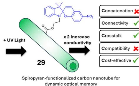
Fig. 33 Spiropyran **29** bound carbon nanotube.<sup>89</sup>
