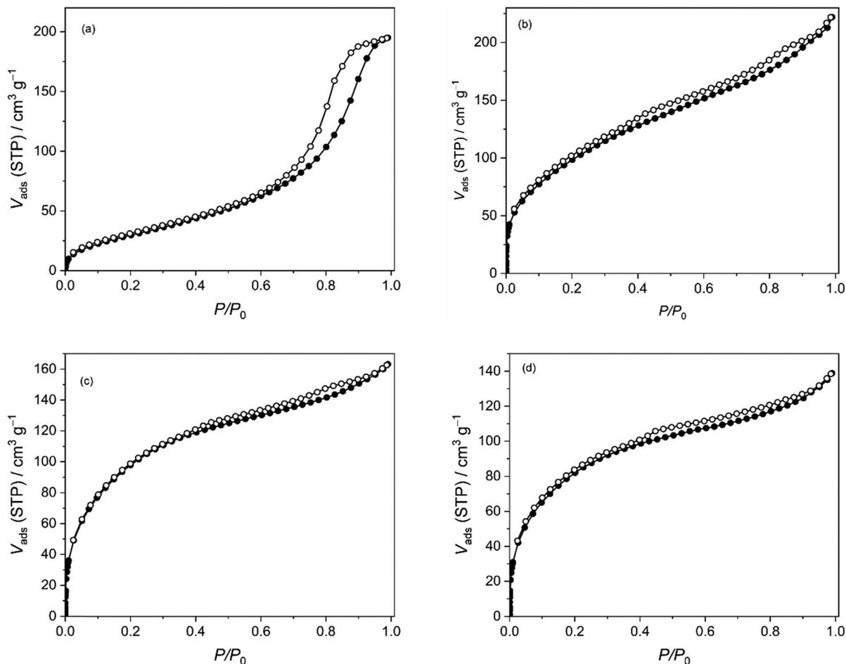
Fig. 10 Argon sorption isotherms for the (a)  $\text{Fe}_3\text{O}_4$ , (b)  $\text{Fe}_3\text{O}_4@TiO_2$ , (c)  $\text{Fe}_3\text{O}_4@TiO_2$ -CPTES nanostructures and (d) the immobilized nickel-PNP pincer complex at 87 K.
