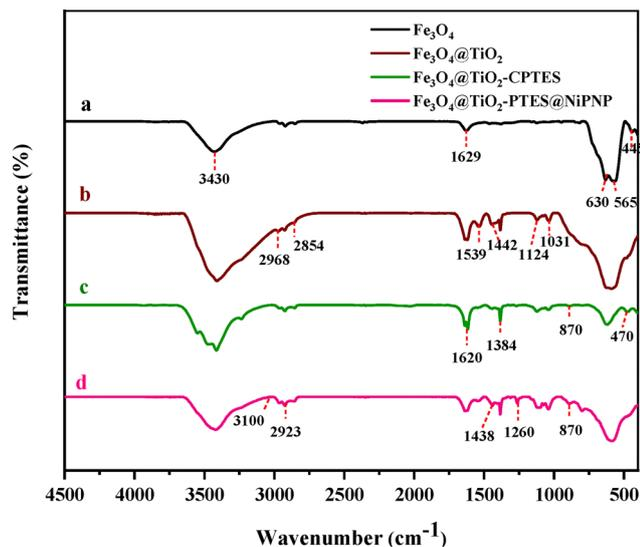
Fig. 1 FT-IR spectra of (a)  $\text{Fe}_3\text{O}_4$ , (b)  $\text{Fe}_3\text{O}_4@TiO_2$ , (c)  $\text{Fe}_3\text{O}_4@TiO_2$ -CPTES nanostructures, and (d) the immobilized nickel-PNP pincer complex,  $\text{Fe}_3\text{O}_4@TiO_2$ -PTES@NiPNP.
