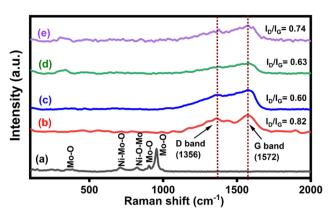
Fig. 2 Raman spectra of (a) NiMoO<sub>4</sub>, (b) CNS, (c) NiMoO<sub>4</sub>/C (D25), (d)  $NiMoO_4/C$  (D50) and (e)  $NiMoO_4/C$  (D75).
