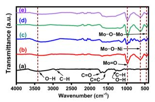
Fig. 3 FT-IR spectra of (a) CNS, (b) NiMoO<sub>4</sub>, (c) NiMoO<sub>4</sub>/C (D25), (d)  $NiMoO_4/C$  (D50) and (e)  $NiMoO_4/C$  (D75).
