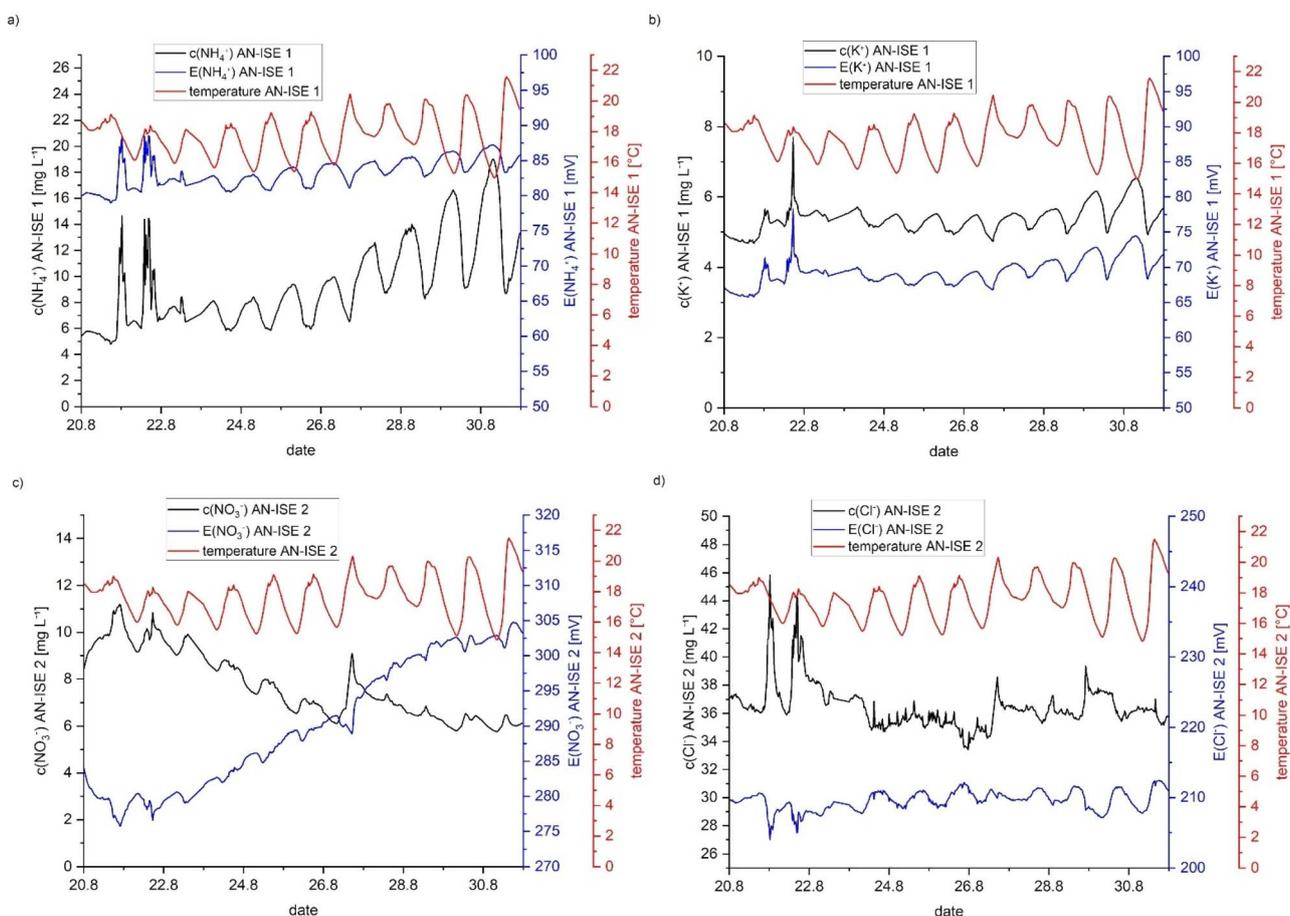
Fig. 2 Temperature dependent fluctuations in the mV signals and concentration readings of (a)  $\text{NH}_4^+$  (AN-ISE 1), (b)  $\text{K}^+$  (AN-ISE 1), (c)  $\text{NO}_3^-$  (AN-ISE 2), (d)  $\text{Cl}^-$  (AN-ISE 2); Bickenalb River, 20.–30.08.2022.
