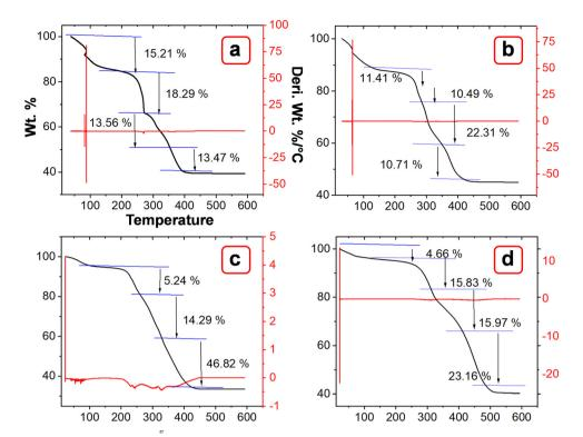
Fig. 7 TGA and DTA profiles of (a) P1, (b) P2, (c) P3, and (d) P4.
