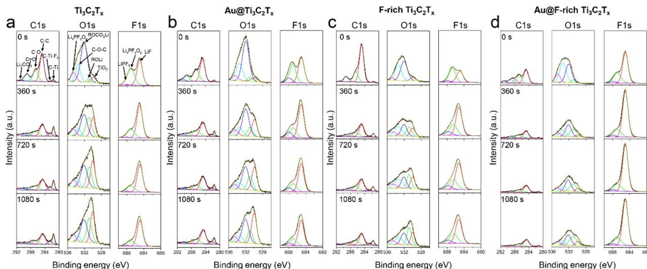
Fig. 3 XPS depth analysis of (a)  $\text{Ti}_3\text{C}_2\text{T}_x$ , (b) Au@ $\text{Ti}_3\text{C}_2\text{T}_x$ , (c) F-rich  $\text{Ti}_3\text{C}_2\text{T}_x$  and (d) Au@F-rich  $\text{Ti}_3\text{C}_2\text{T}_x$  after Li deposition of  $0.1 \text{ mA h cm}^{-2}$ .
