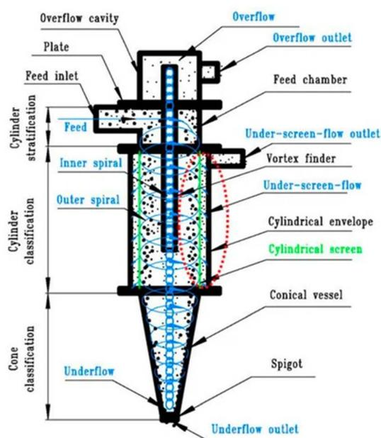
Fig. 9 Hydrocyclone mechanism.<sup>94</sup>
