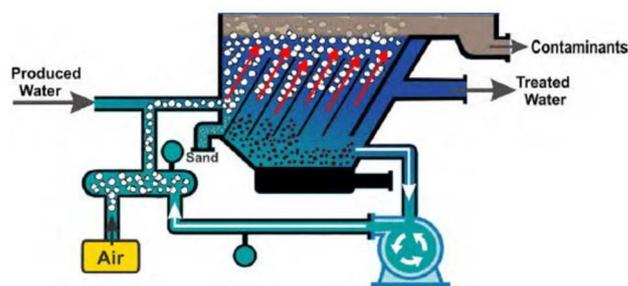
Fig. 12 Flotation mechanism.<sup>109</sup>
