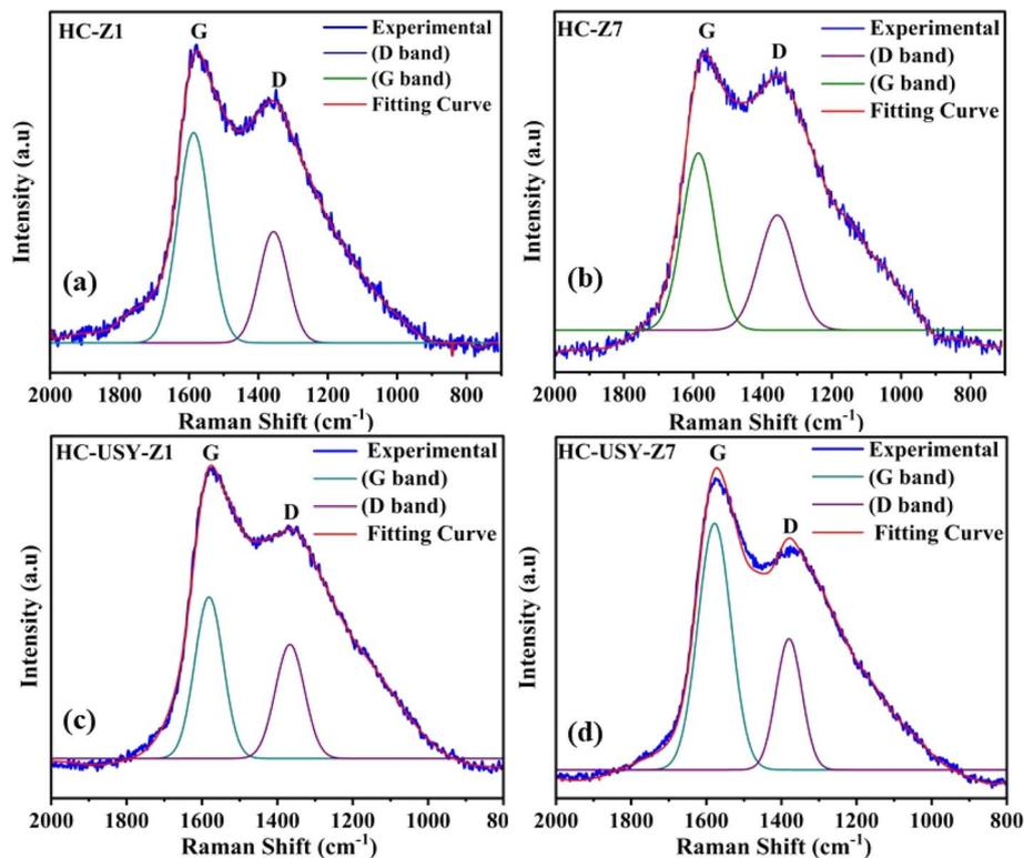
Fig. 9 Raman spectra of catalyzed HC (a) HC-Z1, (b) HC-Z7, (c) HC-USY-Z1, (d) HC-USY-Z7.
