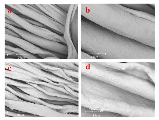
Fig. 6 (a) SEM image of cotton. (b) SEM image of cotton (10 000×). (c) SEM image of cotton-q-VPU. (d) SEM image of cotton-q-VPU (10 000×).
