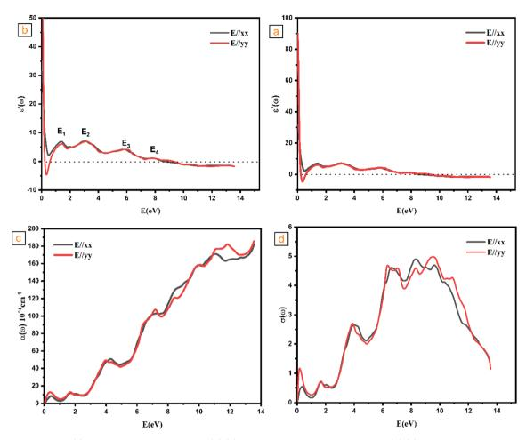
Fig. 4 Optical properties: (a) the real dielectric constants  $\varepsilon_1(\omega)$ , (b) the imaginary dielectric constants  $\varepsilon_2(\omega)$ , (c) the absorption coefficient  $\alpha(\omega)$ , and (d) real part of optical conductivity le long de [100] et [010] directions cristallographiques qui sont représentées respectivement par les directions xx et yy.
