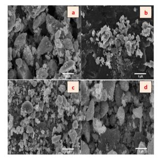
Fig. 5 (a-d) SEM images of  $Fe_2O_3$ - $Ag_2O$ ,  $Fe_2O_3$ - $Ag_2O@GO$ ,  $Fe_2O_3$ - $Ag_2O@S$ -GO and  $Fe_2O_3$ - $Ag_2O@N$ -GO NCs.
