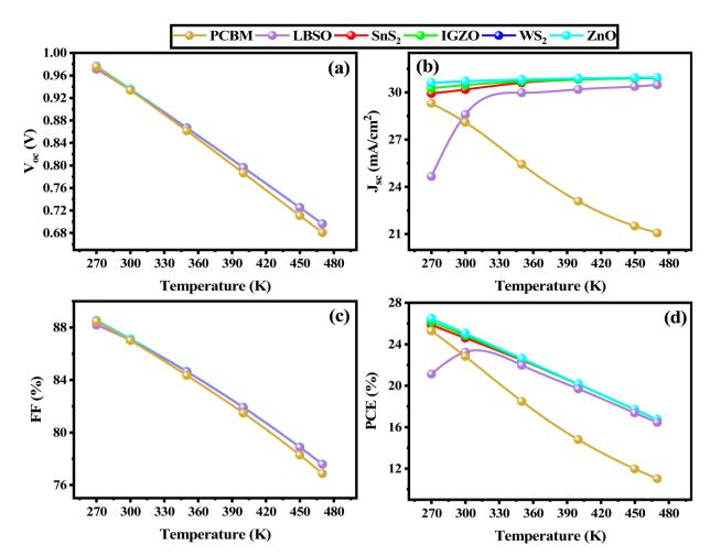
Fig. 17 Influence of variation in temperature on (a)  $V_{\rm OC}$ , (b)  $J_{\rm SC}$ , (c) FF, and (d) PCE.
