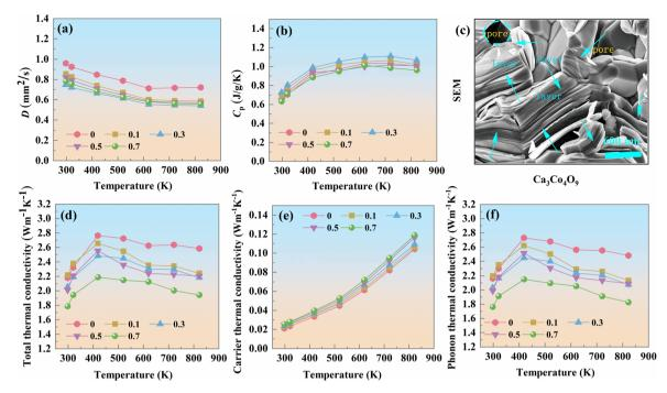
Fig. 4 (a) D; (b)  $C_p$ ; (c) layered structure; (d)  $\kappa_{tot}$ ; (e)  $\kappa_c$ ; and (f)  $\kappa_l$  of CCO@xZnO
