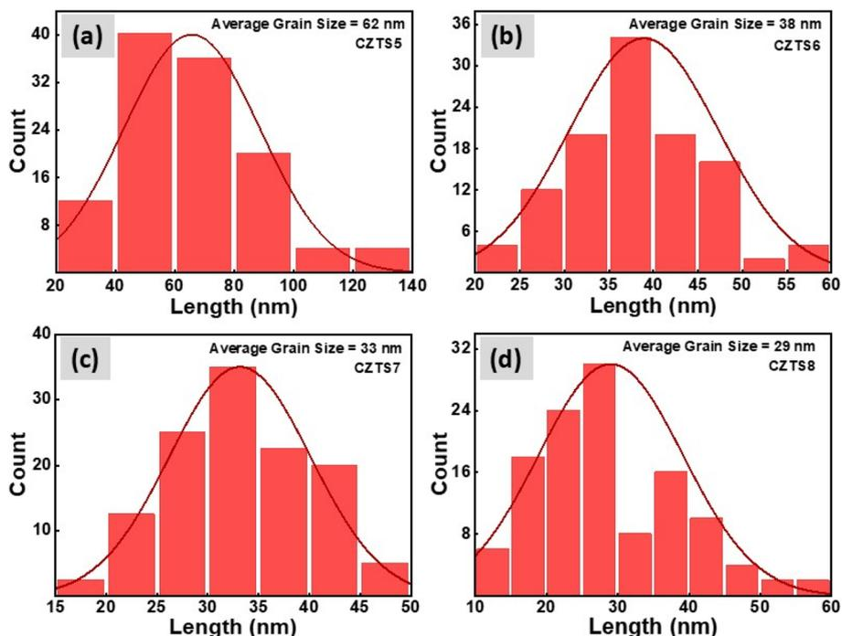
Fig. 6 Grain size histogram of (a) CZTS5, (b) CZTS6, (c) CZTS7, (d) CZTS8.
