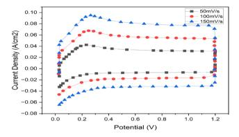
Fig. 2 Cyclic voltammogram of  $\rm RuO_2$  at 50 mV  $\rm s^{-1}$ , 100 mV  $\rm s^{-1}$ , 150 mV  $\rm s^{-1}$ .
