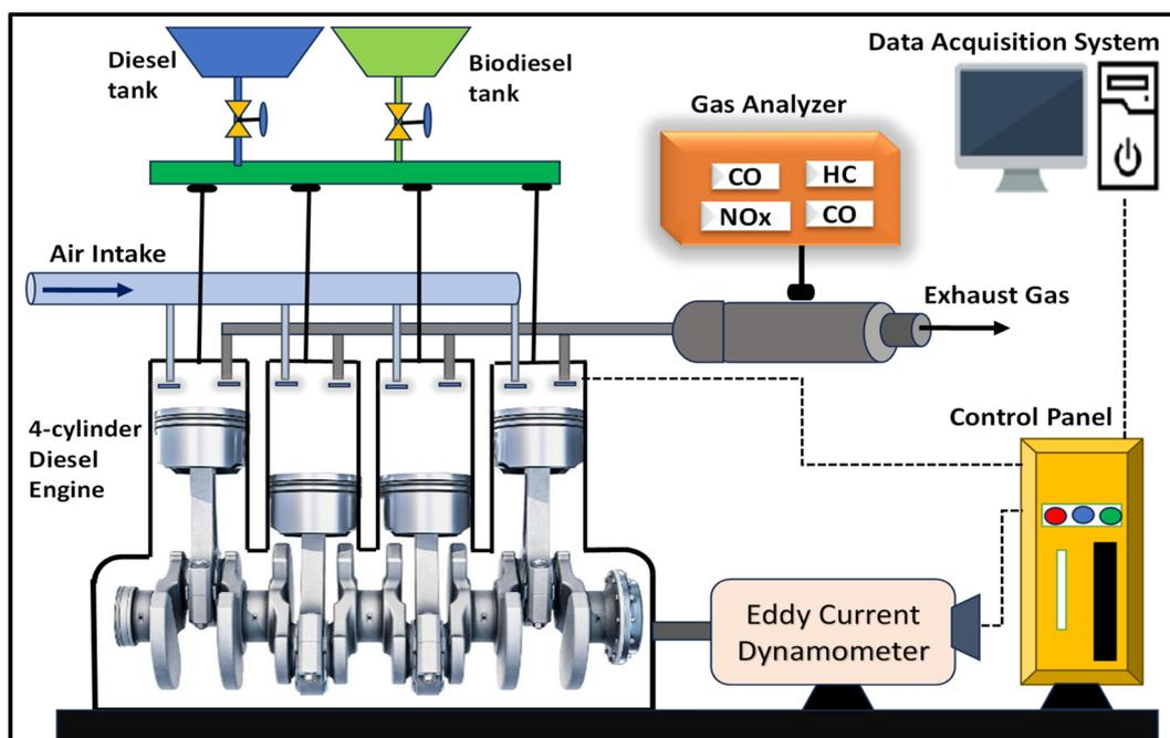
Fig. 2 Experimental set-up.<sup>56</sup>
