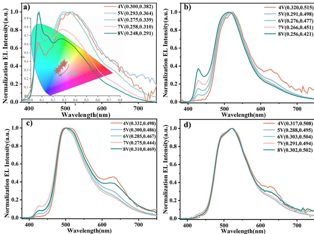
Fig. 5 EL spectra of CzPAF-DPA-based devices: (a) EML (20 mg mL<sup>-1</sup>), (b) EML (30 mg mL<sup>-1</sup>), (c) EML (40 mg mL<sup>-1</sup>), (d) EML (50 mg mL<sup>-1</sup>).
