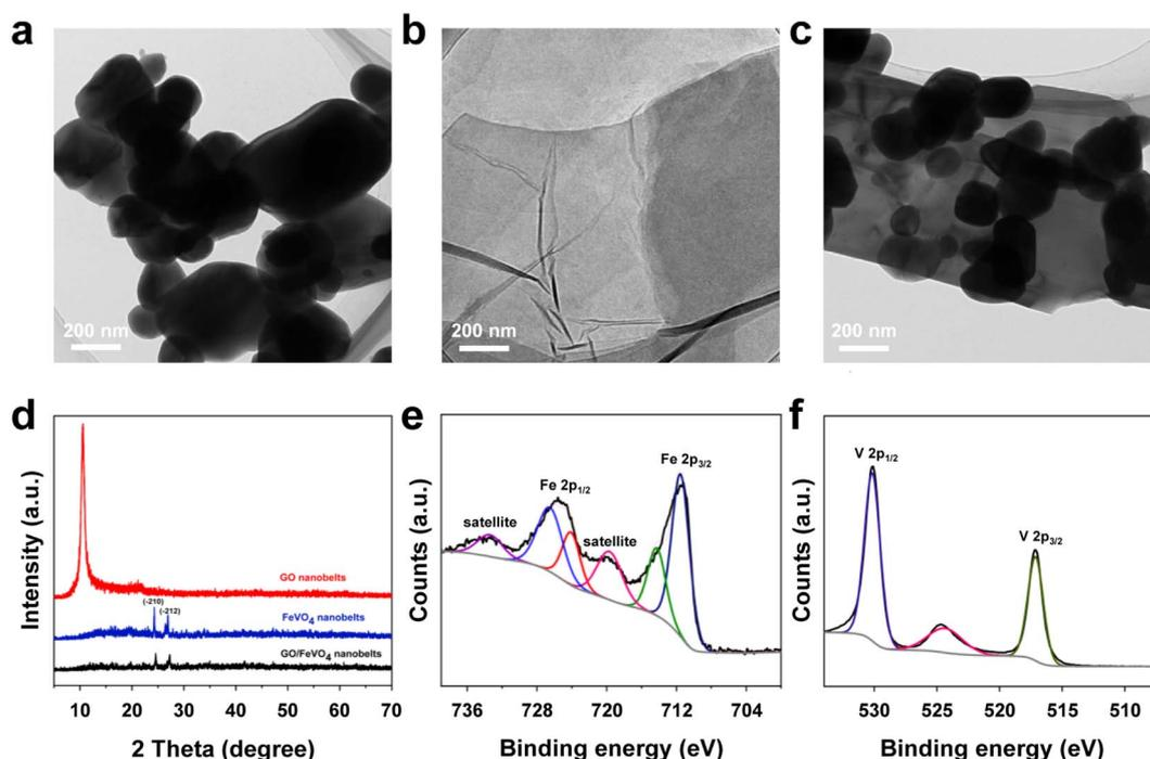
Fig. 1 TEM images of  $\text{FeVO}_4$  (a), GO (b) and  $\text{GO/FeVO}_4$  (c); XRD patterns (d) of  $\text{FeVO}_4$ ; Fe 2p (e) and V 2p (f) spectra of  $\text{FeVO}_4$ .
