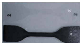
Fig. 3 Tensile test specimens: (a) PE and (b) PVC.
