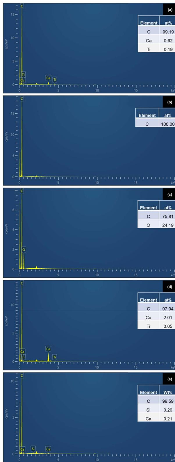
Fig. 5 EDX spectra: (a) PE, (b) PP, (c) PET, (d) PVC, (e) PE (LF).
