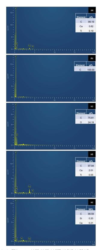
Fig. 5 EDX spectra: (a) PE, (b) PP, (c) PET, (d) PVC, (e) PE (LF).
