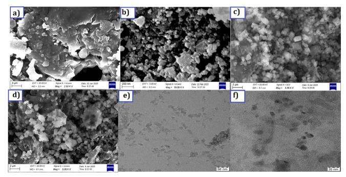
Fig. 2 SEM micrographs of (a) GCN (b) CuZnS (c) CuZnS-GCN20 (d) CuZnS-GCN25; TEM micrographs (e) CuZnS (f) CuZnS-GCN25.
