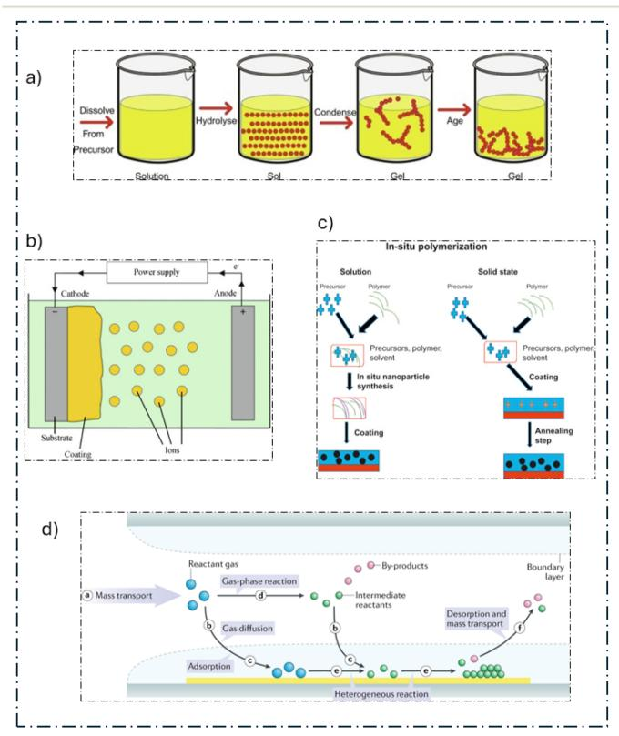
Fig. 2 (a) Sol-gel technique, 65 (b) electrodeposition technique, 66 (c) in situ polymerization, 67 and (d) chemical vapor deposition (CVD). 68
