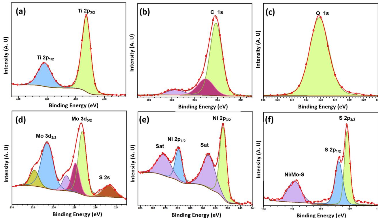
Fig. 4 XPS spectra of NiMo<sub>3</sub>S<sub>4</sub>-MXene.
