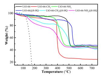
Fig. 5 TGA of UiO-66-X@8-HQ ( $X = -H/-CH_3/-NH_2$ ).
