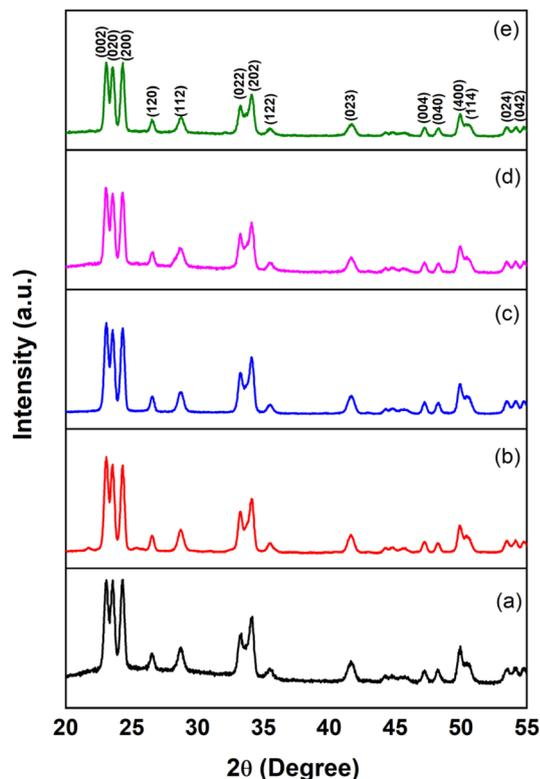
Fig. 3 XRD patterns of (a) pristine  $\text{WO}_3$  (b) CTAB- $\text{WO}_3$  (c) SDS- $\text{WO}_3$  (d) PVP- $\text{WO}_3$  (e) HMT- $\text{WO}_3$ .
