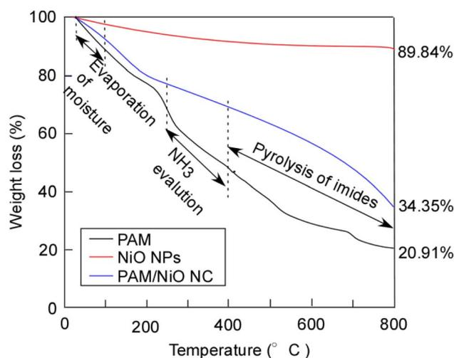
Fig. 12 The TGA thermogram of (—) PAM, (—) NPs, (—) NC.
