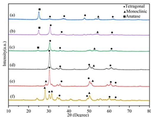
Fig. 1 XRD patterns of  $3\text{SO}_4^{2-}/\text{ZrO}_2\text{-TiO}_2$  catalyst, (a)  $3\text{SO}_4^{2-}/\text{ZrO}_2\text{-TiO}_2$  (1 : 4), (b)  $3\text{SO}_4^{2-}/\text{ZrO}_2\text{-TiO}_2$  (1 : 2), (c)  $3\text{SO}_4^{2-}/\text{ZrO}_2\text{-TiO}_2$  (1 : 1), (d)  $3\text{SO}_4^{2-}/\text{ZrO}_2\text{-TiO}_2$  (2 : 1), (e)  $3\text{SO}_4^{2-}/\text{ZrO}_2\text{-TiO}_2$  (4 : 1), (f)  $3\text{SO}_4^{2-}/\text{ZrO}_2$ .
