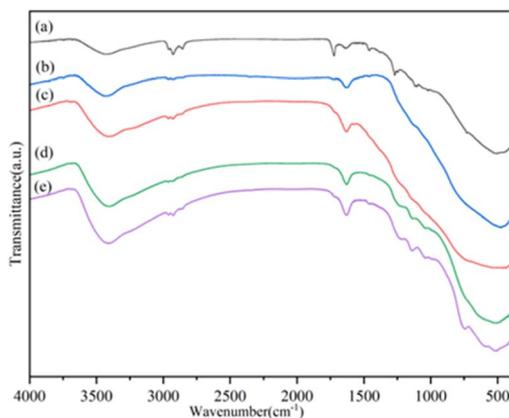
Fig. 2 FT-IR spectra of SO<sub>4</sub><sup>2-</sup>/ZrO<sub>2</sub>-TiO<sub>2</sub> catalyst series. (a) SO<sub>4</sub><sup>2-</sup>/ZrO<sub>2</sub>-TiO<sub>2</sub> (1 : 1), (b) SO<sub>4</sub><sup>2-</sup>/ZrO<sub>2</sub>-TiO<sub>2</sub> (1 : 4), (c) SO<sub>4</sub><sup>2-</sup>/ZrO<sub>2</sub>-TiO<sub>2</sub> (1 : 2), (d) SO<sub>4</sub><sup>2-</sup>/ZrO<sub>2</sub>-TiO<sub>2</sub> (2 : 1), (e) SO<sub>4</sub><sup>2-</sup>/ZrO<sub>2</sub>-TiO<sub>2</sub> (4 : 1).
