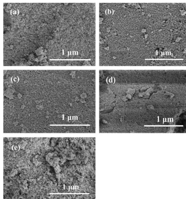
Fig. 3 SEM images of 3SO<sub>4</sub><sup>2-</sup>/ZrO<sub>2</sub>-TiO<sub>2</sub> catalysts, (a) SO<sub>4</sub><sup>2-</sup>/ZrO<sub>2</sub>-TiO<sub>2</sub> (1 : 1), (b) SO<sub>4</sub><sup>2-</sup>/ZrO<sub>2</sub>-TiO<sub>2</sub> (1 : 4), (c) SO<sub>4</sub><sup>2-</sup>/ZrO<sub>2</sub>-TiO<sub>2</sub> (1 : 2), (d) SO<sub>4</sub><sup>2-</sup>/ZrO<sub>2</sub>-TiO<sub>2</sub> (2 : 1), (e) SO<sub>4</sub><sup>2-</sup>/ZrO<sub>2</sub>-TiO<sub>2</sub> (4 : 1).
