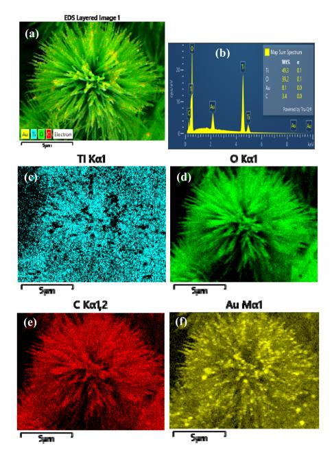
Fig. 2 (a) SEM image, (b) EDS spectrum, (c-f) mapping images of elements for (c) Ti; (d) O; (e) C; (f) Au of UT@Gr-AuNPs.
