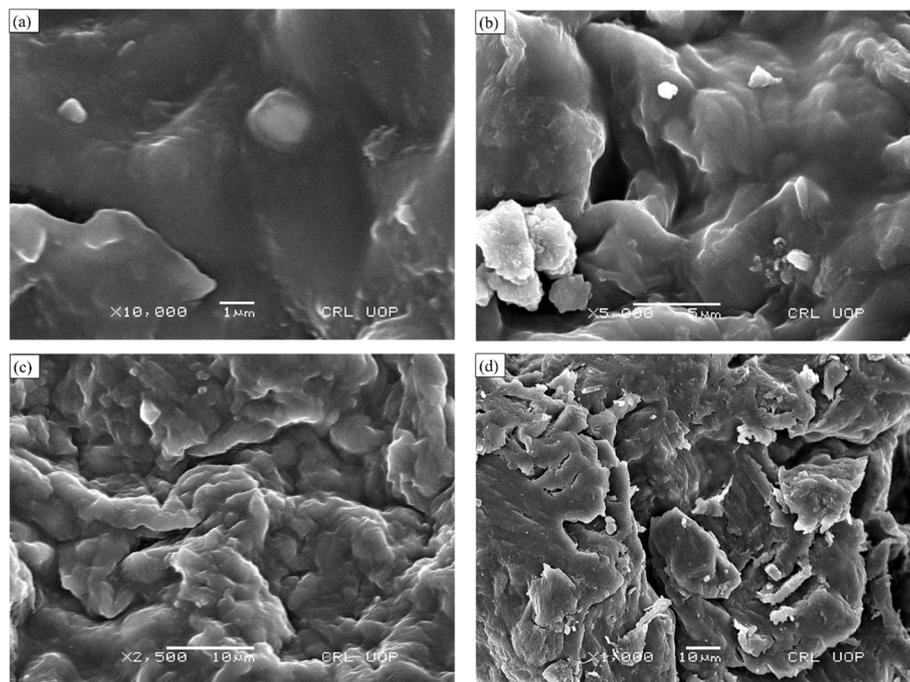
Fig. 10 SEM analysis of CSGI hydrogel at (a) 1  $\mu\text{m}$  and  $\times 10\,000$ , (b) 5  $\mu\text{m}$  and  $\times 5000$ , (c) 10  $\mu\text{m}$   $\times 2500$ , (d) 10  $\mu\text{m}$   $\times 1000$ .
