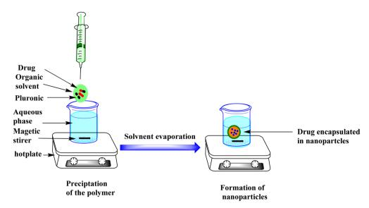
Fig. 8 Nanoprecipitation technique.
