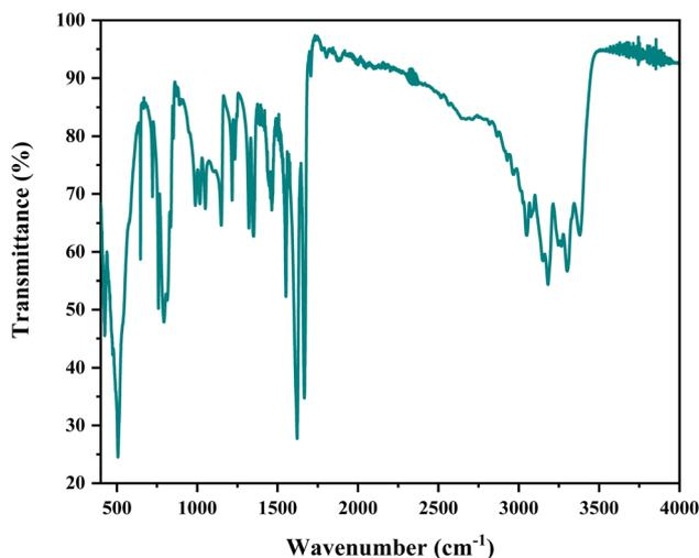
Fig. 6 Infrared spectrum of  $(C_6H_9N_2)_3[BiCl_6]$ .
