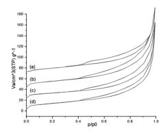
Fig. 3 Nitrogen adsorption—desorption isotherm of (a) Nat-Bent, (b) Bent-Pd-1, (c) Bent-Pd-2 and (d) Bent-Pd-3.
