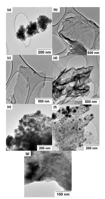
Fig. 3 TEM images of (a)  $ReSe_2$  nanoflowers, (b) rGO, (c) N-rGO, (d)  $g-C_3N_4$ , (e)  $ReSe_2-rGO$ , (f)  $ReSe_2-N-rGO$ , and (g)  $ReSe_2-g-C_3N_4$ .
