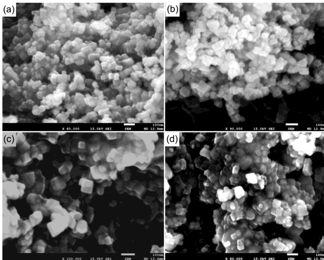
Fig. 6 SEM micrographs of SrTiO<sub>3</sub> nanoparticles: (a) S1-20, (b) S2-20, (c) S1-60, (d) S2-60.<sup>40</sup>
