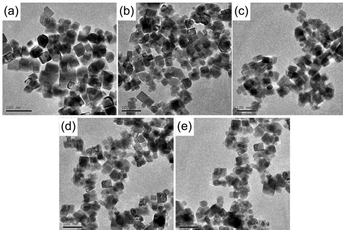
Fig. 8 TEM micrographs of SrTiO<sub>3</sub> nanoparticles: (a) S2-20, (b) S1-40, (c) S2-40, (d) S1-60, and (e) S2-60.<sup>40</sup>
