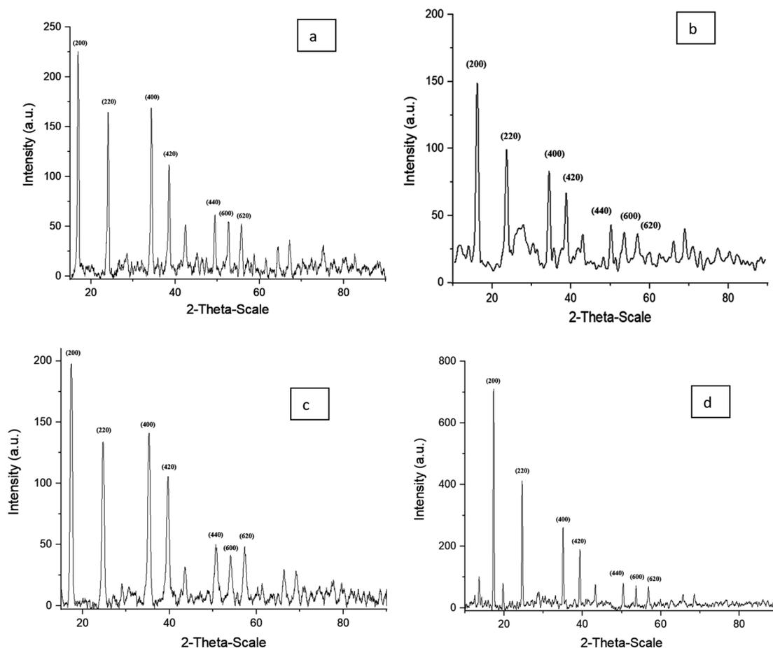
Fig. 1 XRD data of (a) MnHCCo, (b) FeHCCo, (c) NiHCCo, (d) ZnHCCo.
