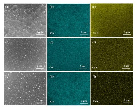
Fig. 8 The SEM and elemental maps of copper oxide/carbon composites.  $CuO_x/CA$ : (a) SEM, (b) C, (c) Cu,  $CuO_x-N/CA$ : (d) SEM, (e) C, (f) Cu,  $CuO_x-S/CA$ : (g) SEM, (h) C, (i) Cu.
