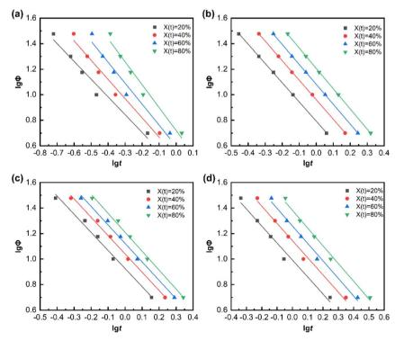
Fig. 9 Iq  $\Phi$ -Iq t curves of PA66 and PA66/MACM6 copolymers: (a) PA66, (b) PA66/MACM6-10, (c) PA66/MACM6-20, (d) PA66/MACM6-30.
